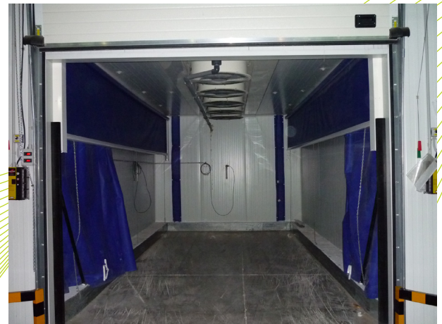
Ilustración 18. Túnel de frío rápido
