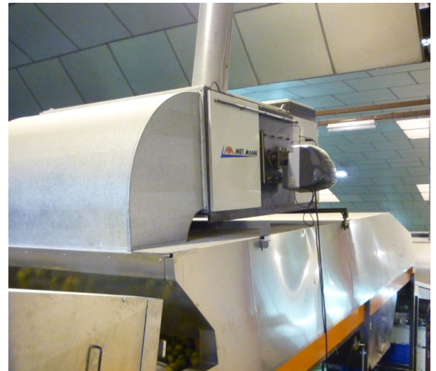
Ilustración 10. Túnel de secado con quemador de gasóleo para cítricos
